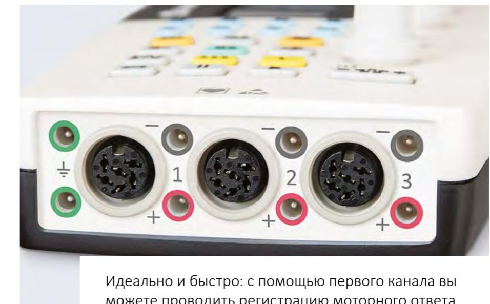
Идеально и быстро: с помощью первого канала вы можете проводить регистрацию моторного ответа, с помощью второго — сенсорного ответа, с помощью третьего — игольчатую ЭМГ. Больше не нужно постоянно перетыкать отводящие кабели. Пусть они прослужат вам еще дольше! Возможна одновременная регистрация по всем трем каналам прибора, например, для записи соматосенсорных ВП
