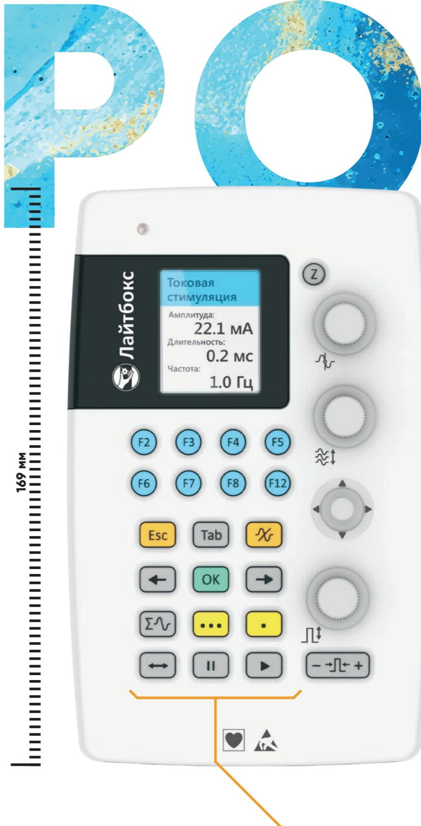
Используя **функциональную клавиатуру**, вы можете легко управлять обследованием, не обращаясь к компьютеру. На панель прибора вынесены кнопки увеличения/уменьшения амплитуды стимула, запуска ритмической стимуляции, подачи одиночного стимула, измерения импеданса и т. д.
